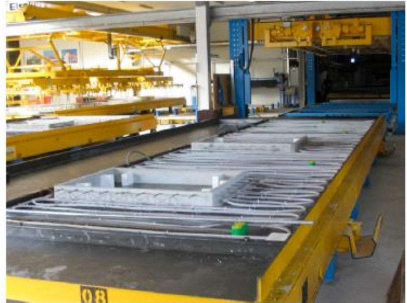
*Einbau der Leitungen für die Thermowände im Werk der Firma Egon Elsässer*
